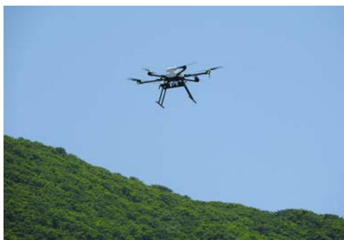
図3 小型衛星通信装置を搭載したドローン
