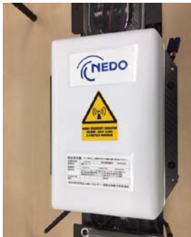
図2 開発した衛星通信装置
